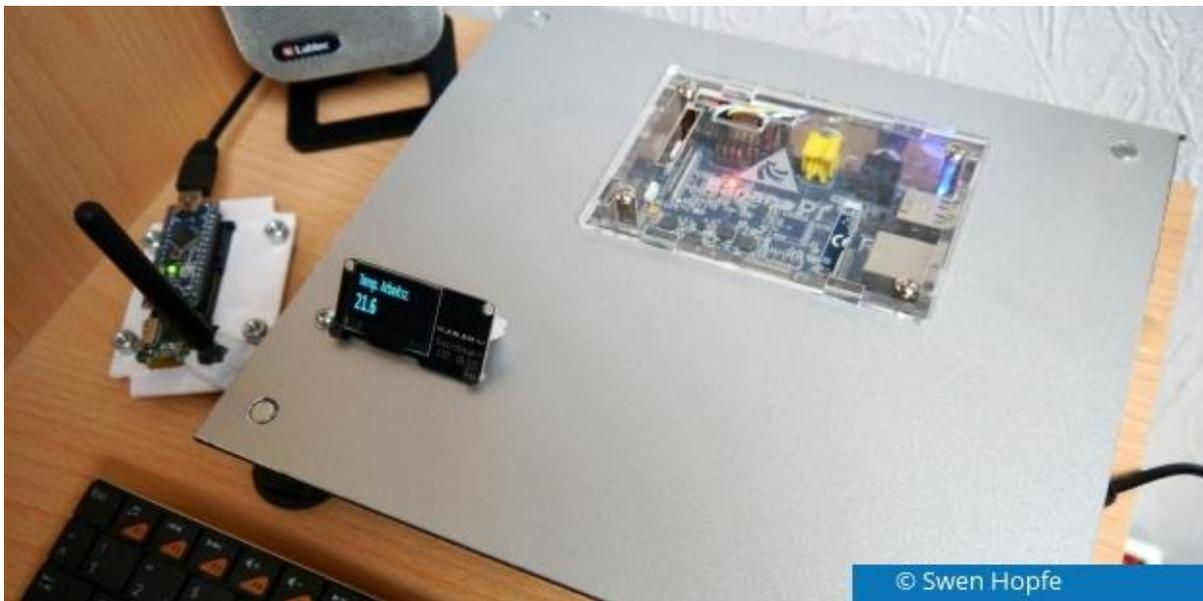
FHEM bietet die Möglichkeit, Hardware verschiedener Hersteller einzubinden, da er eine Reihe von Protokollen unterstützt. Dazu nutzt man unterschiedliche Interfaces. Bei uns sind das zwei Funkinterfaces, ein CUL-Stick von Busware und ein Jeelink-kompatibler Adapter, beide über [USB \(https://www.pcwelt.de/handover/601\)](https://www.pcwelt.de/handover/601) mit dem Pi verbunden.
