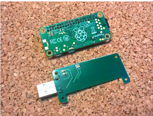
[b03.jpg] USB-Addon und Pi über Pogo-Pins miteinander verbinden
